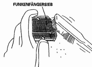
2. Den Funkenschutz in der umgekehrten Reihenfolge der Demontage montieren.
