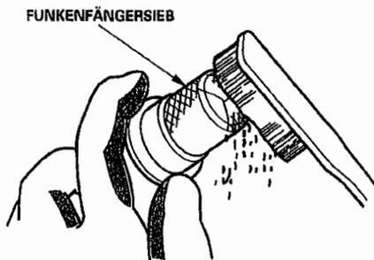
1. Den Funkenschutz in der umgekehrten Reihenfolge der Demontage montieren.
