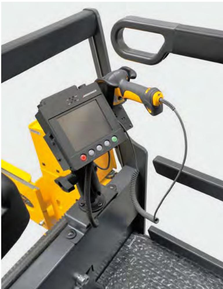
EKG 515 inklusive Datenfunkterminal und Scanner, montiert an Brüstung
