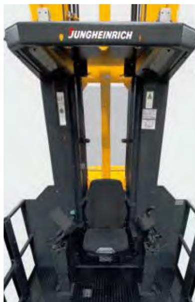
EKH 515, geteilte Bedienpulte und Umbau zu einem Kommissionierfahrzeug
