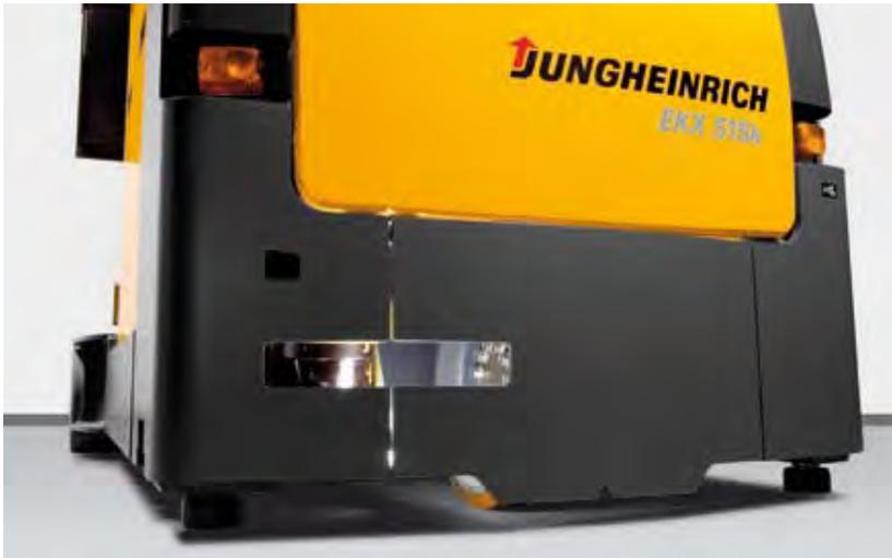
Geschützter Laserscanner in einem EKK 515k
