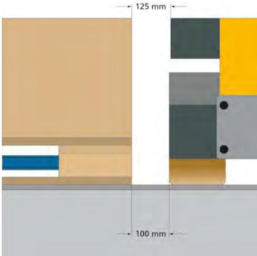
Sicherheitsabstände bei Induktivführung
