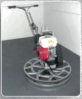
Der Gas-Hebel und der Totmannschalter können mit einer Hand bedient werden. Somit bleibt die zweite Hand frei. Das gibt absolute Sicherheit.
