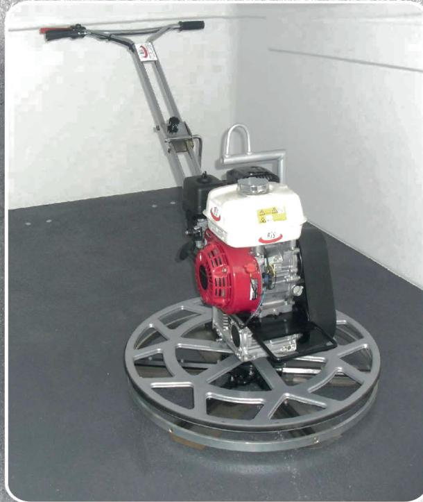
Der Gas-Hebel und der Totmannschalter können mit einer Hand bedient werden. Somit bleibt die zweite Hand frei. Das gibt absolute Sicherheit.
