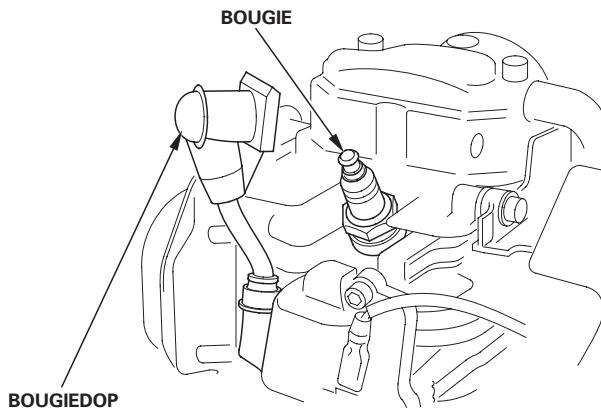
4. Inspecteer de bougie. Vervang hem als hij beschadigd is of erg vervuild en als de afdichtring in slechte conditie is of als de elektrode versleten is.
