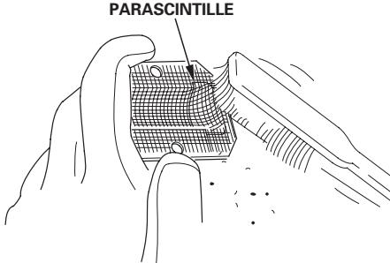
2. Installare il parafiamma nell'ordine inverso a quello di rimozione.
