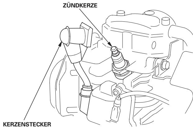
4. Die Zündkerze überprüfen. Die Zündkerze auswechseln oder wenn sie beschädigt oder stark verschmutzt ist, wenn die Dichtungsscheibe in schlechtem Zustand ist oder die Elektroden abgenutzt sind.
