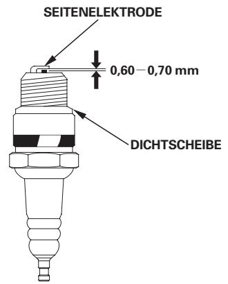
5. Den Elektrodenabstand der Zündkerze mit einer Drahtfühlerlehre messen. Den Elektrodenabstand erforderlichenfalls durch vorsichtiges Biegen der Seitenelektrode korrigieren. Sollelektrodenabstand: 0,60 – 0,70 mm
