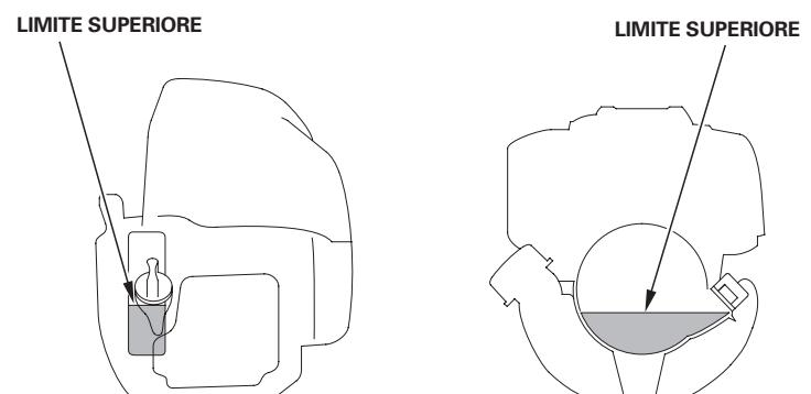
5. Reinstallare saldamente il tappo di rifornimento/astina di livello dell'olio. Se viene versato dell'olio, toglierlo con un panno.
