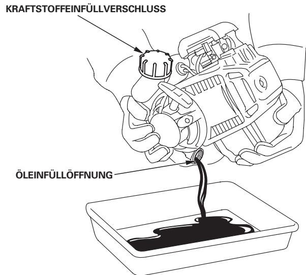
4. Das empfohlene Öl (siehe Seite 8) bei waagerecht liegendem Motor bis zum Erreichen der Unterkante der Öleinfüllöffnung einfüllen.
