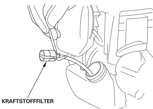
5. Wasser- und Schmutzablagerungen vom Kraftstofftank entfernen, indem das Innere des Kraftstofftanks mit einem nicht entflammbaren Lösemittel oder einem solchen hohen Flammpekts ausgespült wird.
