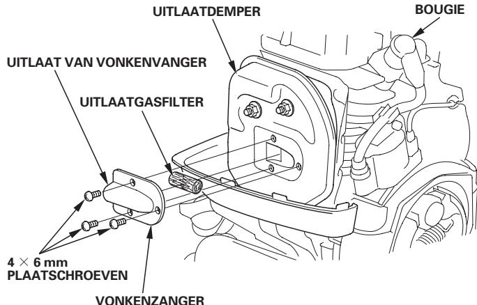
**Inspectie & reiniging van uitlaatgasfilter**
