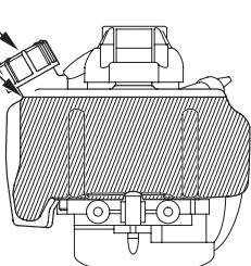
Om bij te tanken zet u de motor op de grond met de brandstofvuldop boven, zoals aangebeeld. Verwijder de brandstofvuldop en vul de tank met benzine tot onderaan de vulhals. Vul zorgvuldig bij om morsen van brandstof te voorkomen. Vul niet te veel bij. In de vulhals mag geen brandstof staan. Breng na bijvullen de brandstofvuldop aan en zet deze stevig vast.
