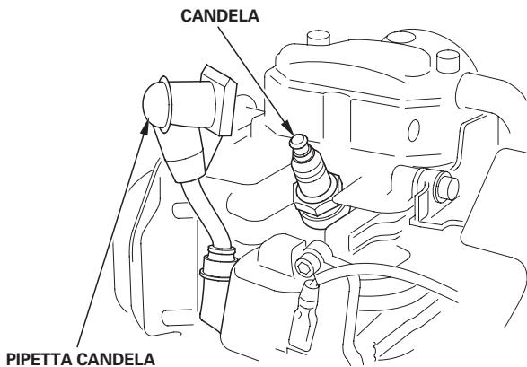
4. Ispezionare la candela. Sostituirla se è danneggiata o molto imbrattata, se la rondella di tenuta è in cattive condizioni o se l'elettrodo è usurato.
