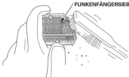
2. Abgasfilter und Funkenschutz in der umgekehrten Reihenfolge der Demontage montieren.
