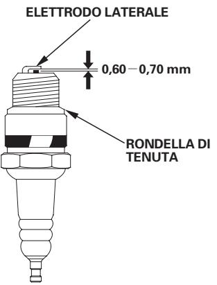
6. Installare la candela con precauzione, a mano, per evitare di avvitarla male.
