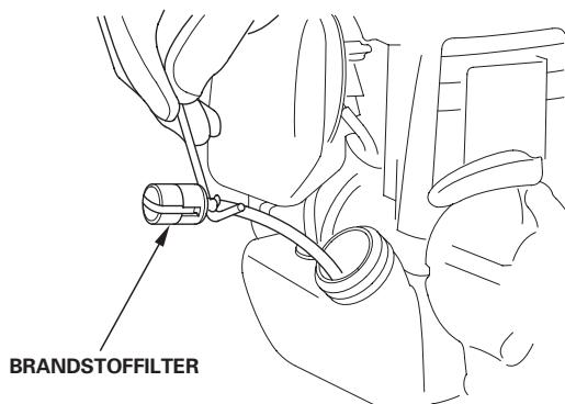
5. Verwijder het in de tank achtergebleven water en vuil door de ruimte in de tank schoon te spoelen met een niet of moeilijk ontvlambaar oplosmiddel.
