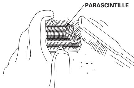
2. Installare il filtro di scarico e il parafiamma nell'ordine inverso a quello di rimozione.
