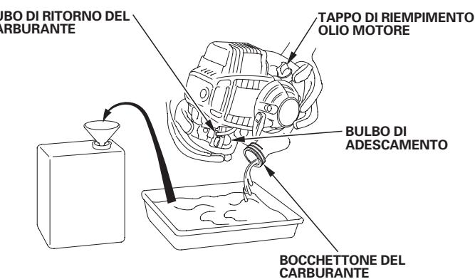
5. Dopo aver scaricato tutto il carburante, reinstallare saldamente il tappo di rifornimento del carburante.
