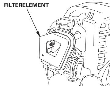
4. Breng het luchtfiltterelement en het luchtfilterdeksel weer stevig aan.
