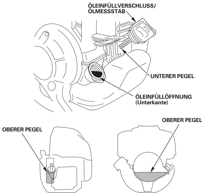
4. Den Öleinfüllverschluss/Messstab wieder einsetzen und sicher anziehen.
