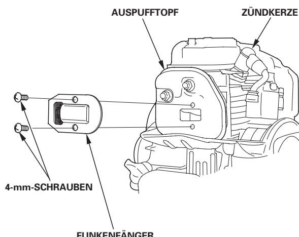
**Reinigung und Überprüfung des Funkenschutzes**
