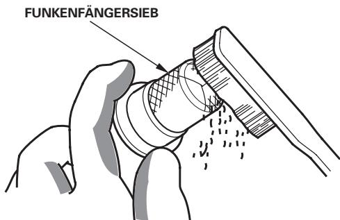
2. Den Funkenschutz in der umgekehrten Reihenfolge der Demontage montieren.
