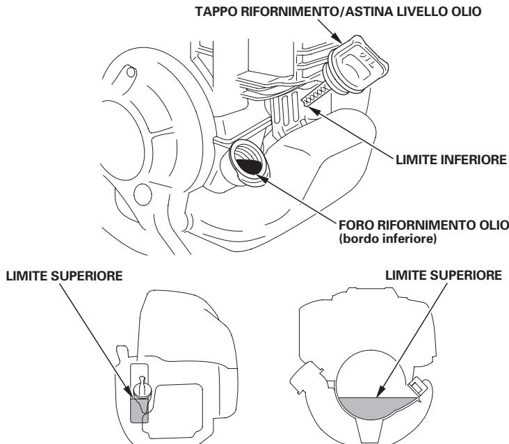
4. Reinstallare il tappo di rifornimento/astina di livello dell'olio e serrarlo saldamente.
