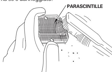
2. Installare il filtro di scarico e il parafiamma nell'ordine inverso a quello di rimozione.
