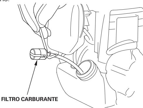
5. Togliere l'acqua e la sporcizia presente nel serbatoio del carburante sciacquandone l'interno con un solvente non infiammabile o ad alto punto di infiammabilità.
