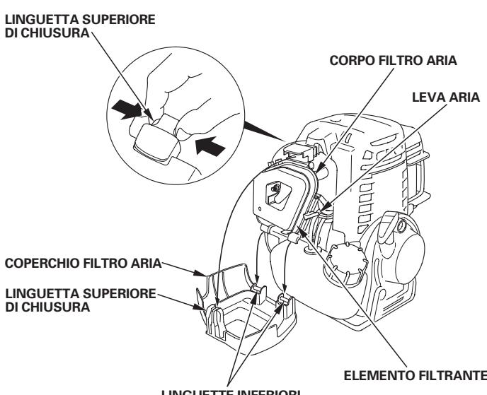
4. Reinstallare saldamente l'elemento filtrante e il coperchio del filtro dell'aria.
