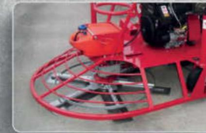
Stabilisierung der Flügelarme
