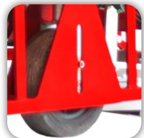
Integriertes Fahrwerk für leichten Transport und einfachen Verschleißwechsel
