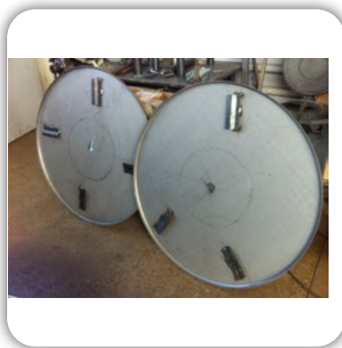
Sonderanfertigung 900 mm mit 5er und 4er Flügelkreuz
