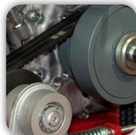
Automatischer Keilriemenspanner für dauerhaft gespannte Keilriemen
