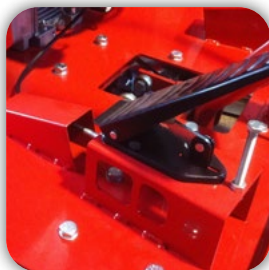
Gaspedal Stufenlose verstellung 40-180 U/min
