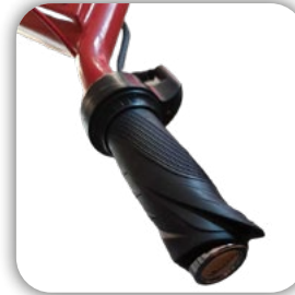
Handgas zur stufenlosen Geschwindigkeitsregulierung
