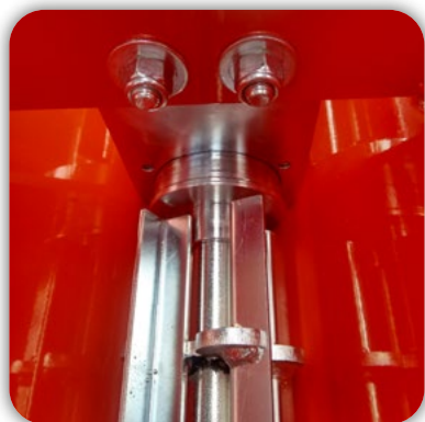
Geschlossene Lager für mehr Zuverlässigkeit
