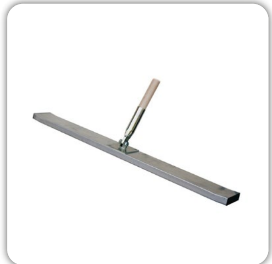
Betonpatsche mit Alu-Hohlprofil und einer Abmessung von 100 x 25 mm, beidseitig geschlossen und an den Außenseiten etwas hochgezogen, damit keine Übergänge entstehen
