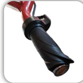
Handgas zur stufenlosen Geschwindigkeitsregulierung
