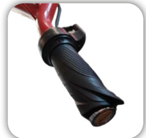
Handgas zur stufenlosen Geschwindigkeitsregulierung
