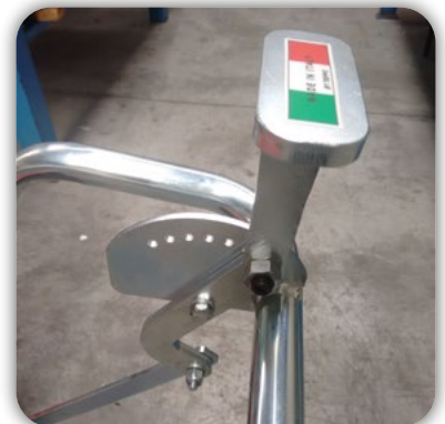
Dosiereinstellung von 1 bis 6 \text{ kg/m}^2
