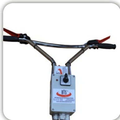
Schalter für Drehgeschwindigkeit 70/140 mit elektrischer Drehrichtungsüberwachung
